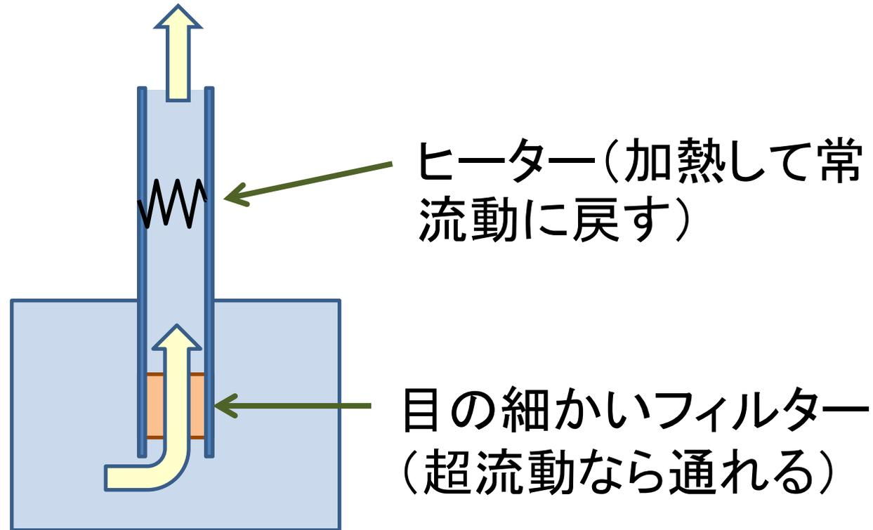
超流動で上に染みこむ. 上ではヒーターで加熱され常流動に戻るので, フィルターを通れなくなり下には戻れない. これにより一方的にHeが供給され, 噴水となる.
