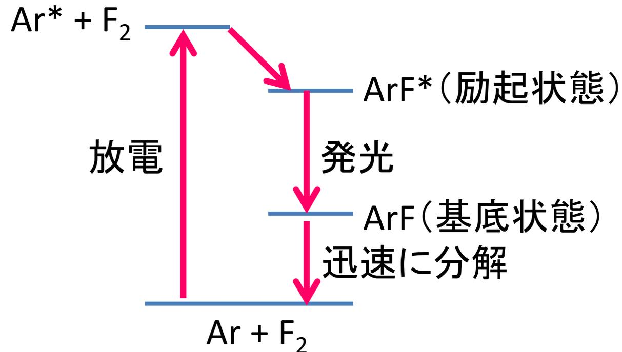
比較的簡単な構造で紫外域の強力なレーザーが得られるので、エキシマレーザーは良く使用される。
