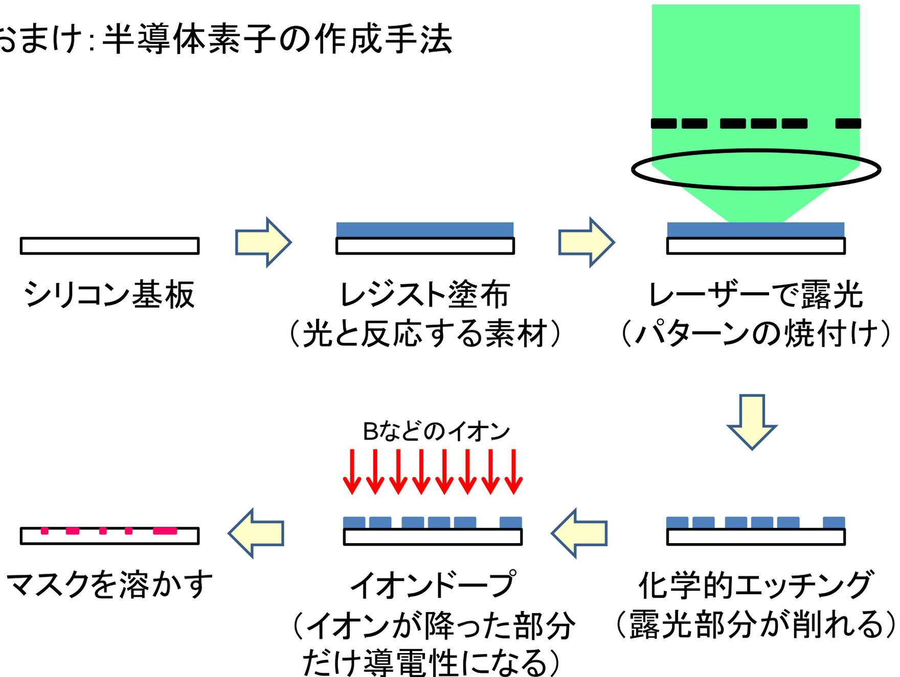
レーザーの波長が短いほど、細い線が露光出来る。
